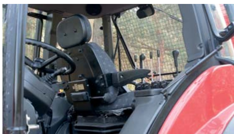
Кабина тягача PRONAR 5135 оснащена поворотным сиденьем, что облегчает оператору управление машиной, находящейся сзади трактора
