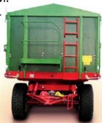
Лестница и балкон, установленные на передней стенке, упрощают сворачивание брезентового покрытия
