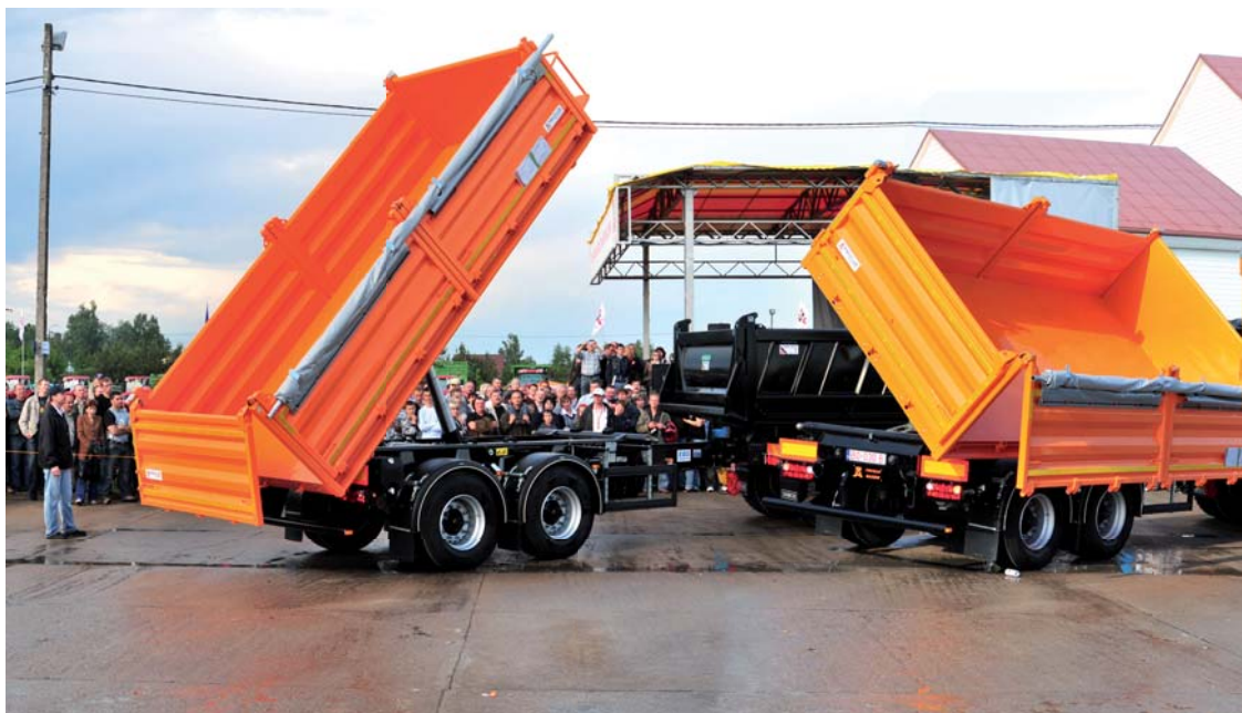
Презентация новинок 2009 г. - Прицеп-самосвал РС2100 с трехсторонней разгрузкой, с центральным расположением осей
