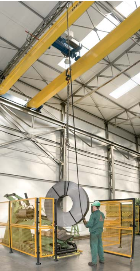
Загрузка нового рулона металла на стержень разматывающего устройства
