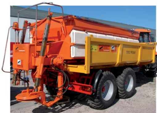
Строительный прицеп T679/2 грузоподъемностью 12 т с песко-разбрасывающей машиной
