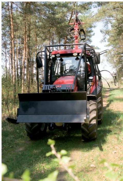
Лесной фронтальный погрузчик LCL16, крепящийся на передней трехточечной навесной системе тягача PRONAR 5135
