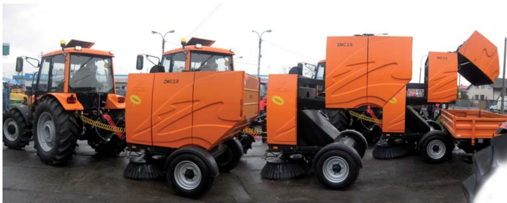
ZMC 2.0 с гидравлически поднимаемым резервуаром емкостью 2,1 м 3 с возможностью опорожнения в контейнер или на прицеп
