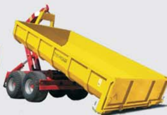
КОНТЕЙНЕРНЫЙ ПРИЦЕП ГРУЗОПОДЪЕМНОСТЬ 10 ТОНН
