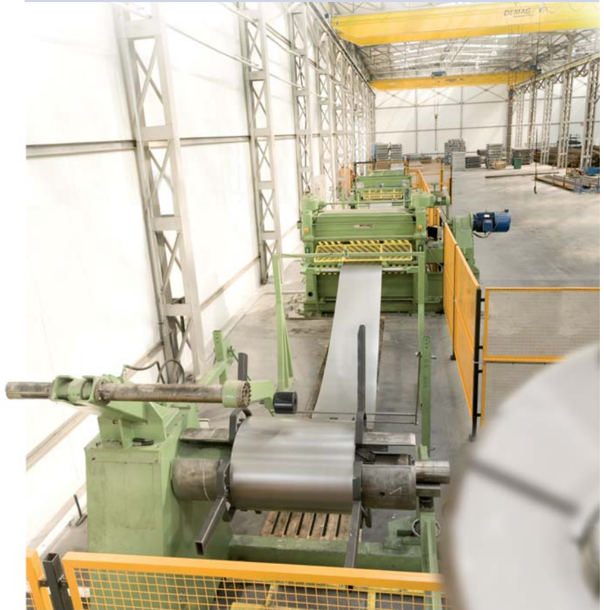
Процесс размотки листового металла
