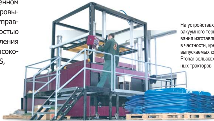
Рабочий изготавливает элементы из пластмассы методом вакуумного термоформования
