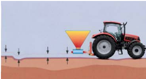
Рис. 5а. Позиционная регулировка. Система удерживает постоянное расстояние от машины до основания. Тем самым обеспечивается равномерное распределение посевного материала или удобрения
