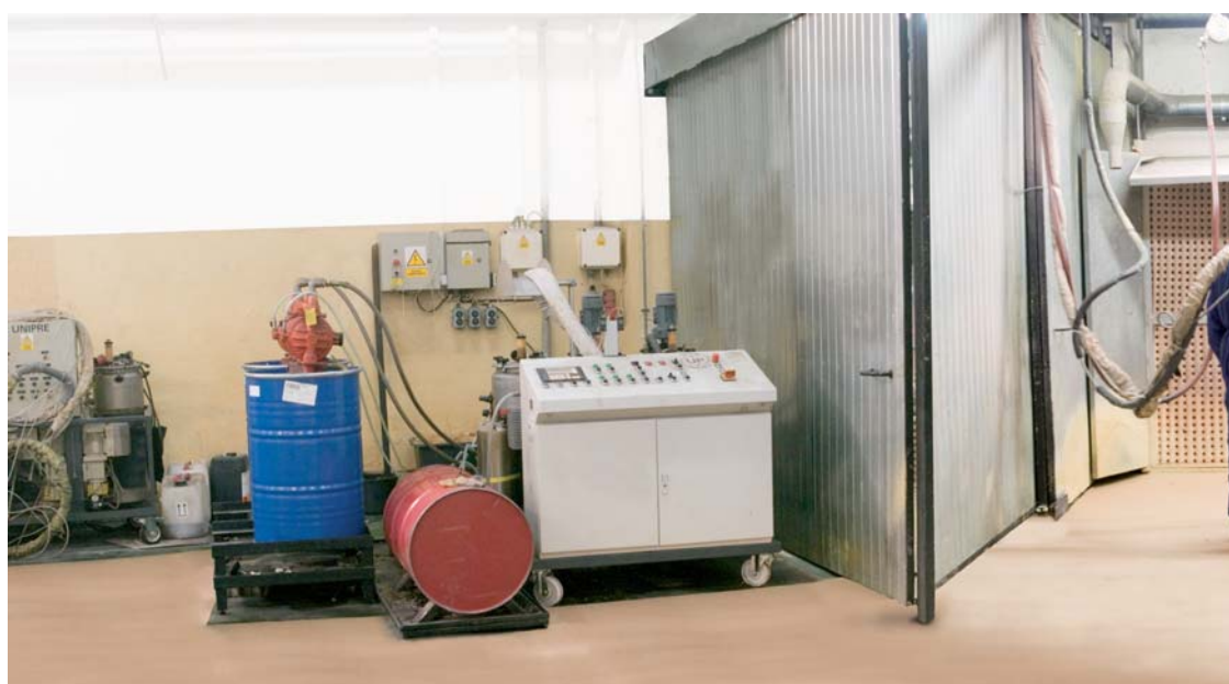
Камера и дозатор для распыления полиуретана
