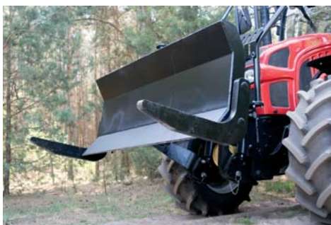
Лесной фронтальный погрузчик LCL16 может быть оснащен гидравлической центральной тягой, позволяющей управлять углом наклона погрузчика, а также его плеч
