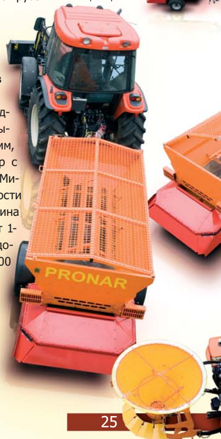
Разбрасыватель T130 грузоподъемностью 2 м³ с трактором Kioti
