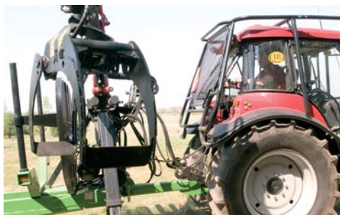
Защитный каркас и дуги безопасности, а также защитная решетка для окна защищают кабину трактора от веток
