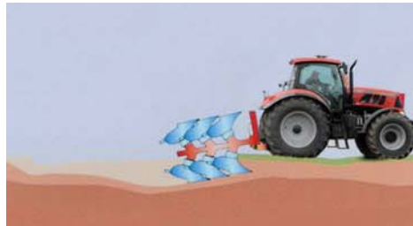
Рис. 5б. Силовая регулировка. Система поддерживает постоянную силу тяги трактора, опуская или поднимая машину. Тем самым достигается оптимальное использование мощности
