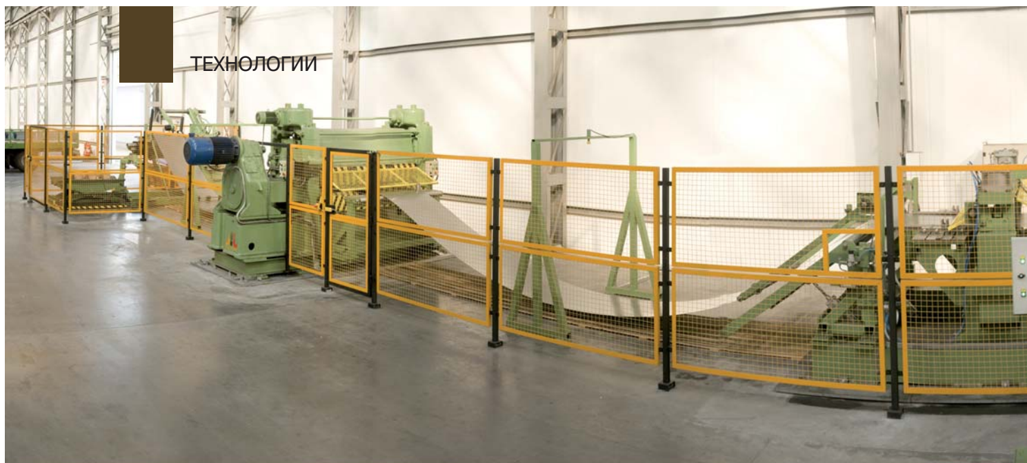
Линия резки металла, полностью оснащенная системами безопасности
