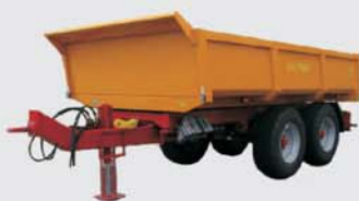
СТРОИТЕЛЬНЫЙ ПРИЦЕП T679/2 ГРУЗОПОДЪЕМНОСТЬ 12 ТОНН
