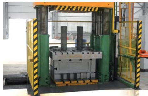
Гидравлический пресс с давлением 1000 тонн оборудован современной оптической системой безопасности
