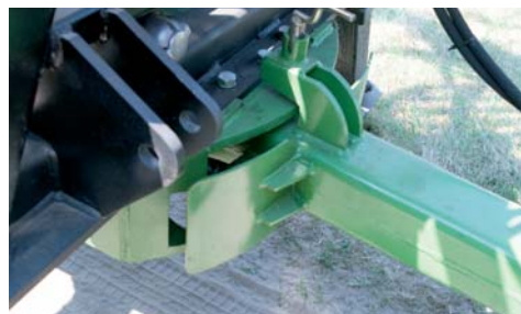
Гидроуправляемое ломаное дышло повышает маневренность прицепа в лесу
