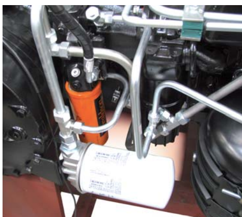
Расположение фильтров в гидравлической системе трактора P6
