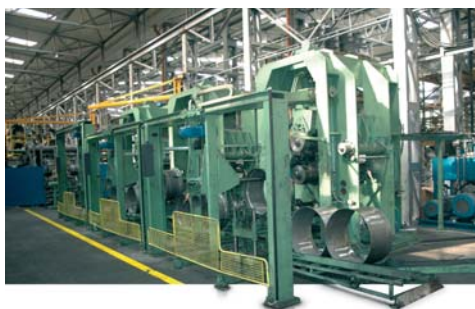
Современная, полностью автоматизированная линия МР5 для профилирования ободов
