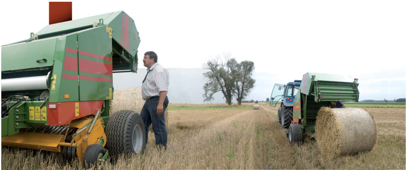
Пресс-подборщик Z-500 во время выгрузки свернутого тюка
